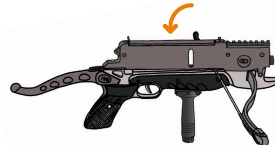
Schließen Sie, nachdem Sie die Pfeile eingefüllt haben, den Deckel des Magazins. Die Armbrust ist nun bereit zum Spannen.
