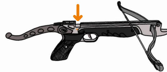
Um die manuelle Sicherung ein bzw. auszubauen benötigen Sie einen Hammer und eine feste Unterlage. Schlagen Sie den beiliegenden Kerbstift mit einigen leichten Schlägen ein paar Millimeter in die kleine Bohrung beim Spannhebel von der rechten Gehäusesseite ein.
