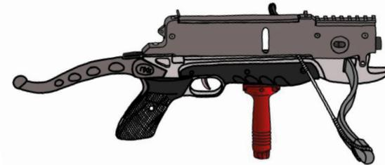
Montieren Sie nun den mitgelieferten schwarzen, vertikalen Vordergriff auf der Montageschiene auf der Unterseite. Im Bild rot markiert.
