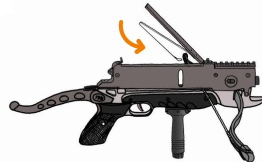
Danach befüllen Sie das Magazin mit bis zu 6 Pfeilen. Fädeln Sie den Pfeil zuerst an der Vorderseite ein, dann lassen Sie den Pfeil in das Magazin fallen.
