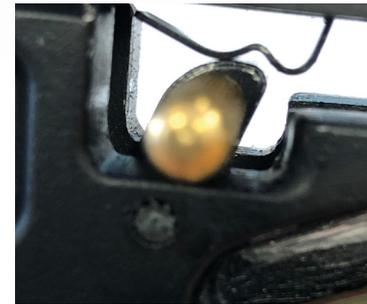
Setzen Sie danach die manuelle Sicherung, wie auf dem Foto abgebildet, in das Gehäuse ein. Schlagen Sie anschließend den Kerbstift in das Gehäuse, bis dieser bündig abschließt. Um die Sicherung auszubauen schlagen Sie diesen Kerbstift wieder aus dem Gehäuse. Schlagen Sie von der Seite auf der der Kerbstift bündig mit dem Gehäuse ist.
