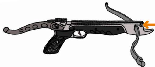
Achten Sie darauf, dass die beiden Markierungen auf der Vorderseite des Wurfarms mittig sind und schrauben Sie den Wurfarm mit der vorderen Schraube fest.
